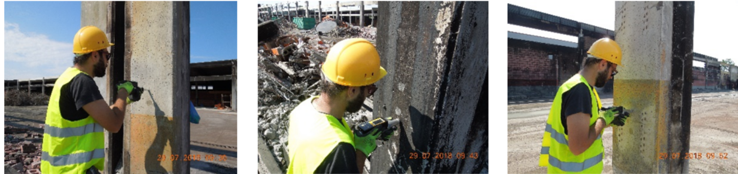
Εικόνα 5: Ενδεικτικές μετρήσεις με κρουσίμετρο.
