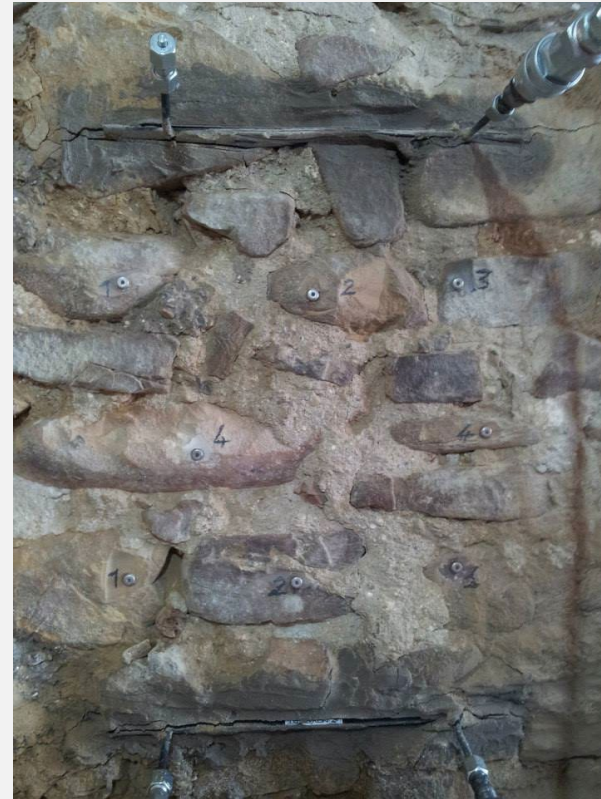
Επίπεδοι Γρύλοι – Flat Jacks (Φέρουσα Λιθοδομή – Υπολογισμός μέτρου Ελαστικότητας)
