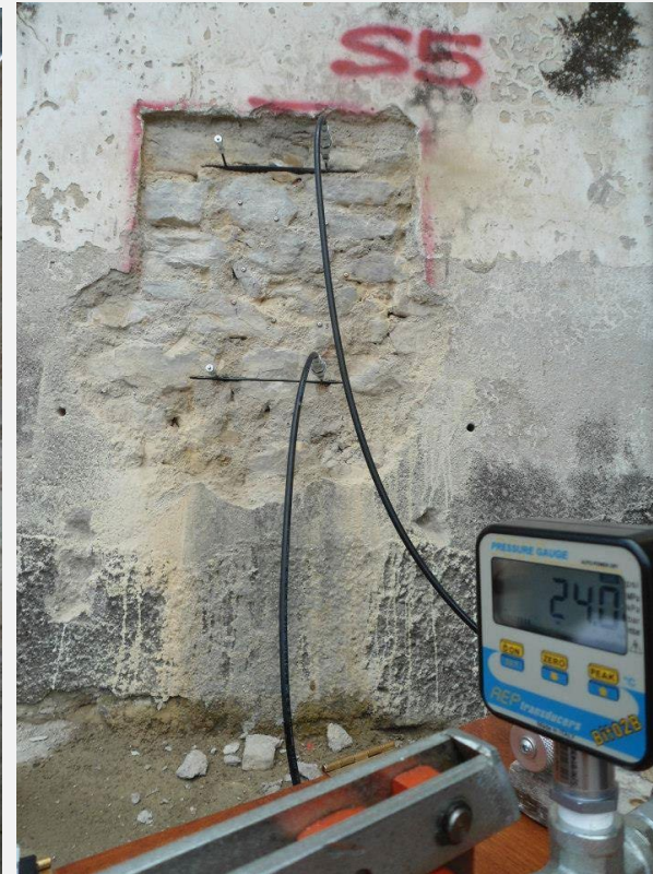
Επίπεδοι Γρύλοι – Flat Jacks (Φέρουσα Λιθοδομή – Υπολογισμός μέτρου Ελαστικότητας)
